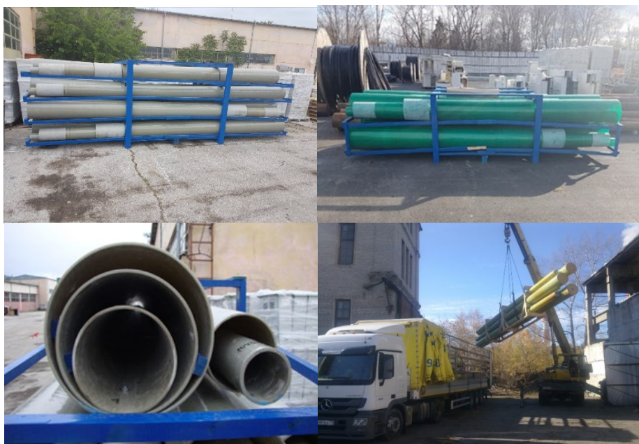
Фиг. 4.20 Транспортна сглобка на 9 полимерни стълба за ЕРП Север и 8 полимерни стълба за ЕВН
